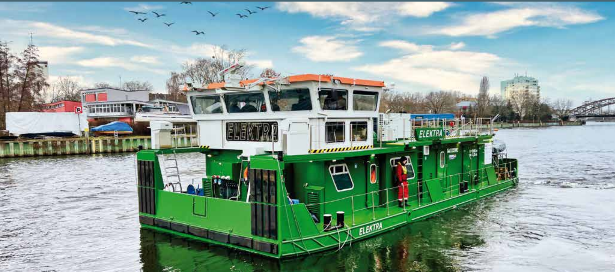
ELEKTRA – das weltweit erste Schubboot mit Elektroantrieb
